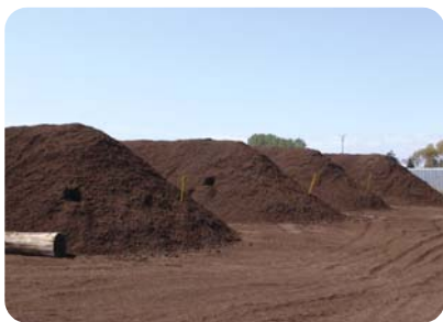
新西兰辐射松树皮在窗子里进行老化。
